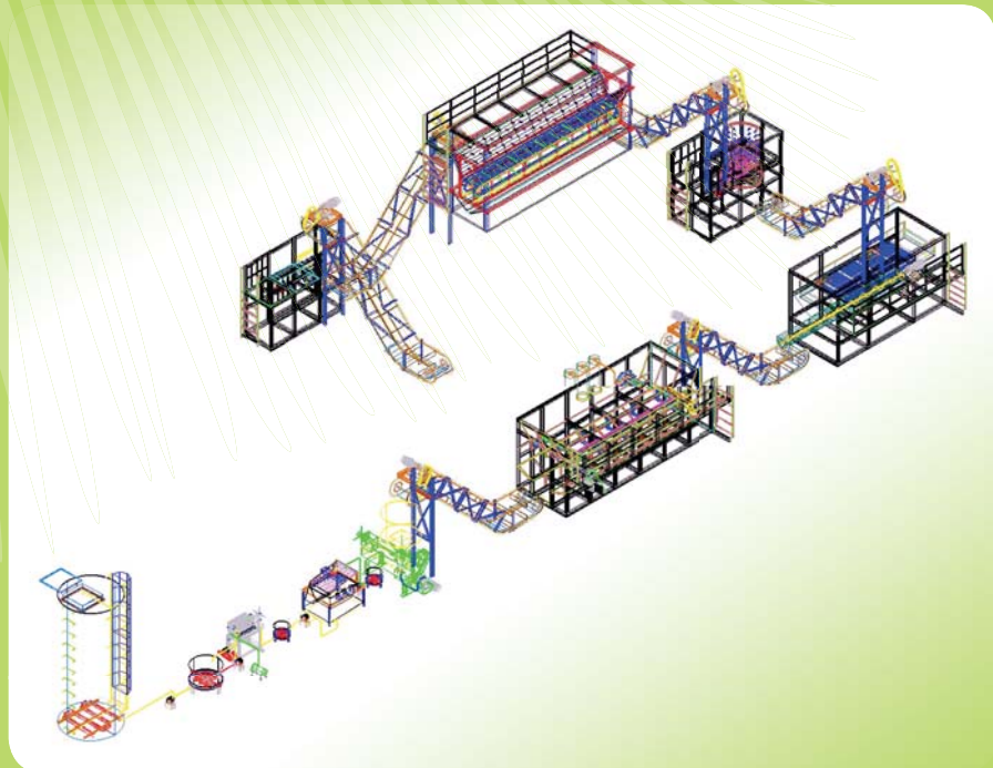
เครื่องสกัดน้ำมันปาล์มระบบแห้งเหีบรวม (Dry Process)
