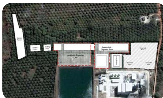
พื้นที่ก่อสร้างระบบก๊าซชีวภาพแบบ Cover In Ground Anaerobic Reactor (CIGAR) ขนาด 25,000 ลูกบาศก์เมตร จำนวน 2 ระบบ ตั้งอยู่บริเวณบ่อน้ำบำบัดน้ำเสียของโรงงานฯ
