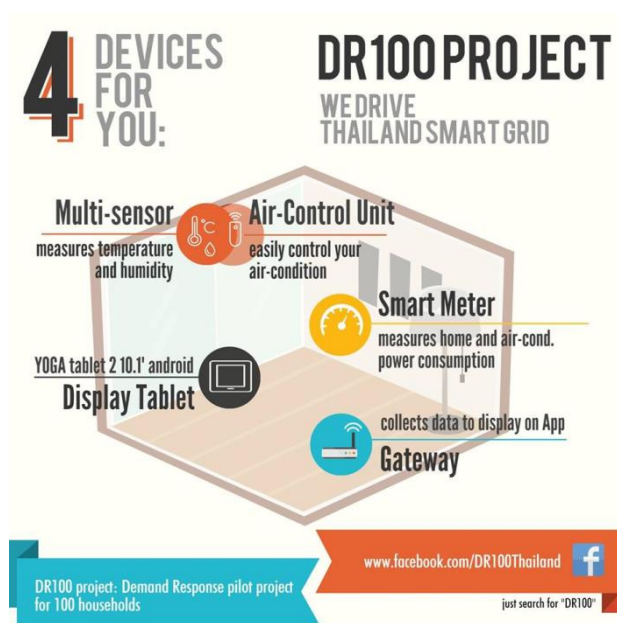
รูปที่ 2-1 รูปแบบการทำงานของระบบในโครงการ DR100 1
