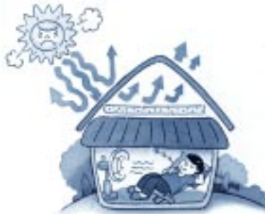
7. ติดตั้งฉนวนป้องกันความร้อน
