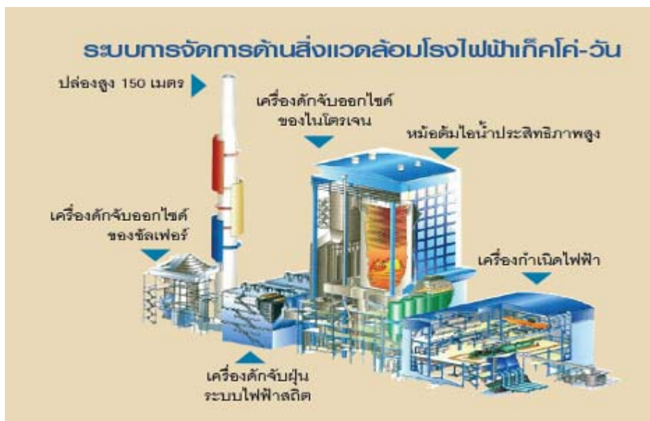
ตัวอย่างระบบนำเทคโนโลยีถ่านหินสะอาดมาใช้ในโรงไฟฟ้าเกิดโค-วัน จ.ระยอง
