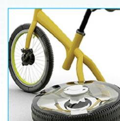
“BiWa” เป็นจักรยานปั่นผ้าของนักออกแบบนามว่า “Barbora Tobolova” ที่ได้แนวคิดมาจากเครื่องจักรยานออกกำลังกายให้พลังงานการซักผ้าที่เรียกว่า “Bicycle Washing Machine-BWM” ซึ่งมีลักษณะอยู่ที่ล้อหมุนในขณะที่ “BiWa” จะเป็นจักรยานสองล้อ ปั่นได้จริงแบบทั่วไป แต่ที่พิเศษคือล้อหลังถูกออกแบบให้เป็นถังเพื่อบรรจุผ้าที่ต้องการทำความสะอาดได้
