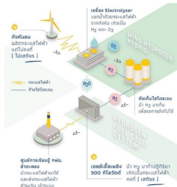
รูปที่ 16: การทำงานของระบบ wind hydrogen hybrid ควบคู่กับเซลล์เชื้อเพลิง ภายใต้โครงการโรงไฟฟ้ากังหันลม ลำตะคอง ระยะที่ 2 (ที่มา: กพผ., 2564 17 )
