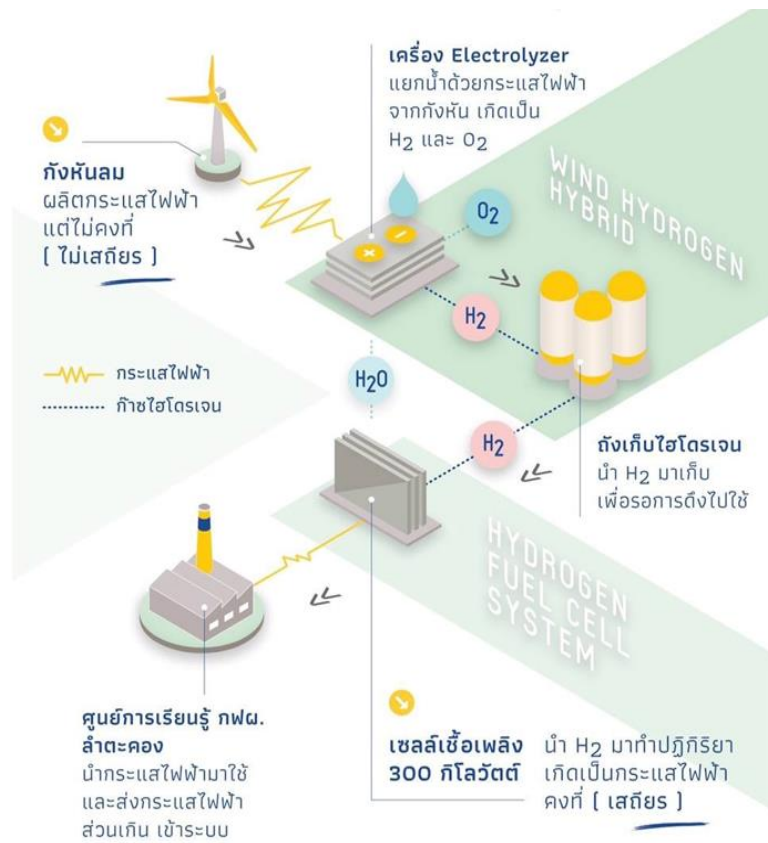
รูปที่ 1: การทำงานของระบบ wind hydrogen hybrid ควบคู่กับเซลล์เชื้อเพลิง ภายใต้โครงการโรงไฟฟ้ากังหันลม ลำตะคอง ระยะที่ 2 (ที่มา: กฟผ., 2564 11 )
